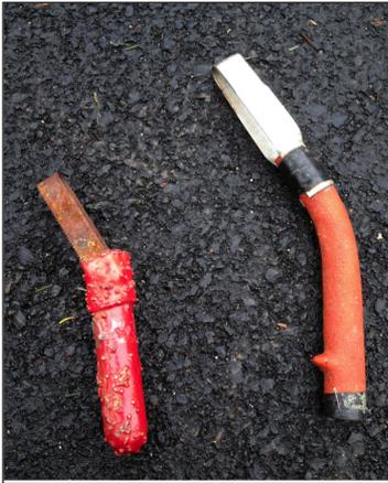
*Otro ejemplo de ponerle una curva a la herramienta en vez de doblar la mano. Los raspadores de pescados pueden tener una curva en el mango o en el raspador para minimizar el riesgo relacionado con la postura. Además, los raspadores también pueden tener conexiones de manguera para hacer el trabajo aún más eficiente.*
